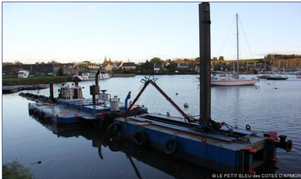
Figure 51 : La vase du piège de Lyvet a été extraite par une barge équipée d'un système d'aspiro-dragage,
